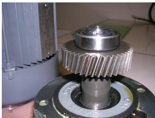
Figure 5: Roue de sortie R4 avec le dépôt de colle sur le flanc d'une dent
