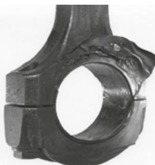
Figure 13 : Grippage d'un palier de bielle
