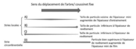
Figure 7 : Faciès typiques dans un palier hydrodynamique
