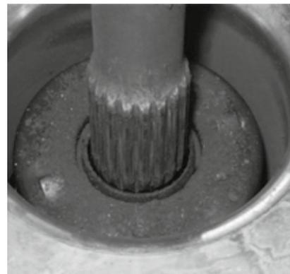
Figure 15 : Liaison cannelée d'une motorisation hybride de véhicule automobile [13]
